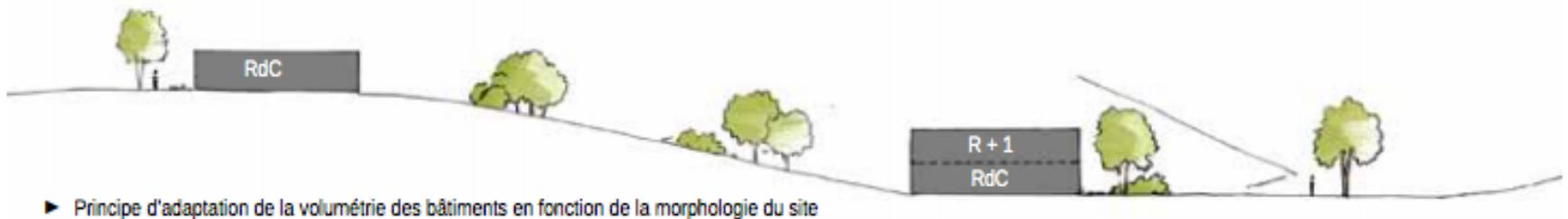
► Principe d'adaptation de la volumétrie des bâtiments en fonction de la morphologie du site
